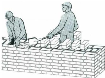
Задание №5 - Каким образом производят кладку примыкания стен по многорядной системе перевязки швов?
